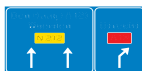
K11 Voorsorteren op niet-autosnelweg. Bord met interlokale doelen, routenummers en verwijzing naar autosnelweg
